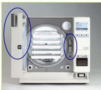
Новый механизм двойной блокировки двери предотвращает случайное открытие иочно удерживает дверь во время цикла стерилизации.
